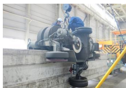
②台車吊り上げ
